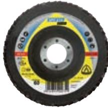
**Einsatzgebiete:** Entfernung von Schweißnähten und Graten, Schlossereien, Anlagenbau, Stahlbau. Zulässige Drehzahl max. 13.300 min<sup>-1</sup>. Arbeitshöchstgeschwindigkeit 80 m/s.
