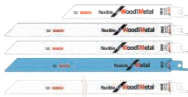
BIM, geschränkt, gefräst. Für Palettenreparatur, Holz mit Nägeln/Metall (<100 mm), Metallbleche, Rohre, Aluminiumprofile (3–12 mm).
