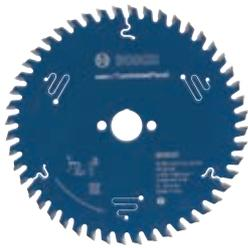
Für saubere Schnitte in Hochdruck-Schichtpresstoffplatten. Geeignet für Trespa-Platten. Zähne aus Microteq, hergestellt aus extra harten, langlebigen Hartmetallkörnern. High-end Beschichtung für zuverlässige Schnittleistung, verhindert Korrosion und reduziert die Reibung. Dämpfungsschlitz für besonders ruhigen Lauf, deutlich weniger Geräusche und geringere Vibrationen. Durch eingerollte Spannungsringe bleiben die Sägeblätter auch im Einsatz formstabil.
