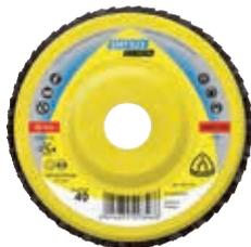
**Einsatzgebiete:** Entfernung von Schweißnähten und Graten in Schlossereien, Anlagenbau und Stahlbau. Grundteller glasfaserverstärkter Kunststoff. Zulässige Drehzahl 13.300 min<sup>-1</sup>. Arbeitshöchstgeschwindigkeit 80 m/s.
