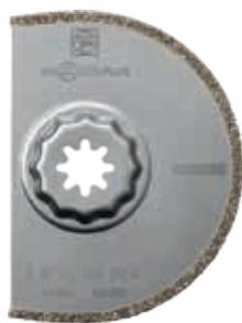
Diamant-Sägeblatt. Zum Austrennen von Marmor-, Epoxidharz und Trassfugen. Hervorragende Standzeit. Auch für sehr harte Epoxid- oder Zementfugen geeignet. Die richtige Wahl für häufigen Einsatz und anspruchsvolle Aufgaben. Universelle Starlock-Aufnahme, passend für alle gängigen Multifunktionswerkzeugen im Markt. Segmentiert, ideal zum Arbeiten in Ecken und an Kanten ohne Überschnitt.
