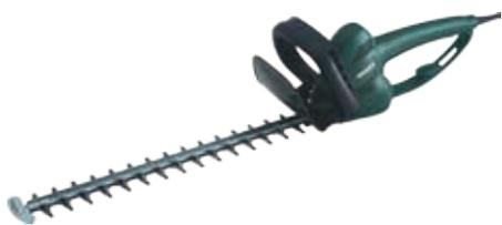
Mechanischer Messerschnellstopp (in 0,05 Sekunden). Sauberer Schnitt durch beidseitig Messerzähne im Winkel von 30°. Sicherheits-Untermesser für hohe Arbeitssicherheit.
