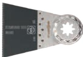
**E-Cut Universal-Sägeblatt.** Bi-Metall mit gewellter Universalverzahnung. Breites Anwendungsspektrum für Blech bis 2mm, Alu-Profilen, Cu-Rohre, Holz, Gipskarton und Kunststoffe. StarlockPlus-Aufnahme, passend für alle gängigen Multifunktionswerkzeugen mit StarlockPlus- und StarlockMax-Aufnahme sowie für alle FEIN MultiTalent und MultiMaster bis 04/16. Schmale, taillierte Form für optimale Schnittgeschwindigkeit und gute Spanabfuhr.
