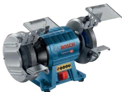
Für härteste Anwendungen. Leistungsstarker Induktionsmotor für verschiedene Arbeitsbedingungen und Verwendungen. Kompaktes Druckgussgehäuse mit gekapselten Kugellagern. Großer und einfach verstellbarer Funkenschutz für sichere und präzise Arbeit. Einstellbarer Werkstückträger. Gummifüße sorgen für schwingungsarmes Stehen. Staubgeschützer Ein- und Ausschalter. Einfacher Scheibenwechsel.
