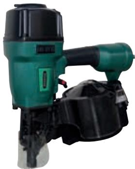
Für Coilnägel Type CNW von 45–90mm. Einzel- und Kontakttauslösung, Auslösesicherung, Tiefeneinstellung, Abdruckschutz, Geräuschdämpfer, rückschlagfrei, Abluft verstellbar.
