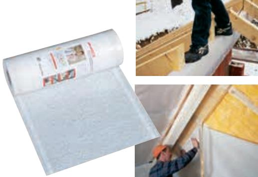
Die einfache und zeitsparende Art Dampfbremsen und Dampfsperren anzuschließen. Folie mit rutschhemmender Oberflächenstruktur gewährleistet sichere Begehbarkeit auch bei Nässe. PFETEX wird über die Pfette gelegt und angeheftet, nach dem Anbringen der Dämmung wird die Dampfbremse an Pfetex angeklebt. Vorgeklebte Klebebänder haben eine hohe Klebekraft und bringen Zeitorsparnis bei der Ausführung der Anschlussklebung. Abfallfreie Verlegung. B2, flammhemmend nach DIN 4102.
