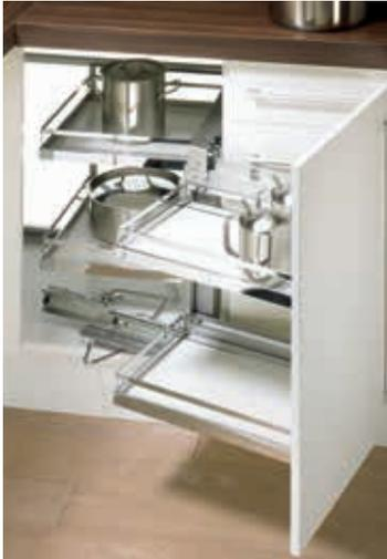
Einsetzbar für Eckschrankbreiten 900 und 1.000 mm über einfache Rastverstellung des Ausziehbeschlages. Lichte Mindestkorpustiefe 500 mm, mit kugelgelagertem Vollauszug. Stahl, pulverbeschichtet silber.
