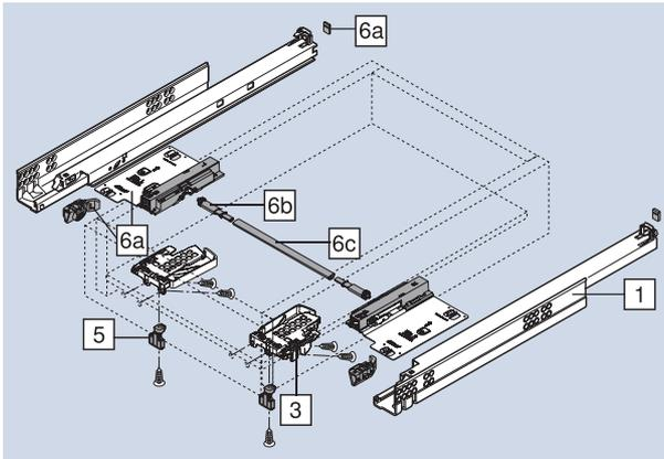
Verdeckter TANDEM-Vollauszug mit integrierter BLUMOTION für sanftes und leises Schließen. TANDEM inside für schwebelichten Lauf, ein Möbelleben lang. Werkzeuglose Höhenverstellung über Kupplung. Werkzeuglose integrierte Front-Neigungsverstellung. Toleranzausgleich seitlich und in der Tiefe.
