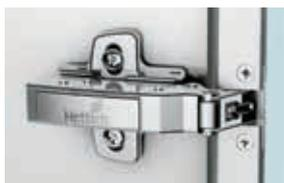
Mit integrierter Dämpfung. Für 19 mm breite Aluminiumrahmenprofile. Mit Schließautomatik. Scharniertopf Zinkdruckguss vernickelt.
