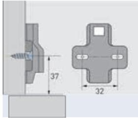
Lochabstand 32mm. Mit Langlöchern, Ø 5,4mm für Höhenverstellung +/- 2mm. Befestigung mit Senkholzschrauben, Ø 4,5mm. Stahl/Zinkdruckguss vernickelt, Abstand Lochreihe 37mm.
