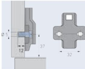
Lochabstand 32mm, mit vormontierten Direktbefestigungsschrauben für Bohr-Ø 5x12mm. Langlöcher für Höhenverstellung +/- 2mm. Stahl/Zinkdruckguss vernickelt, Abstand Lochreihe 37mm.
