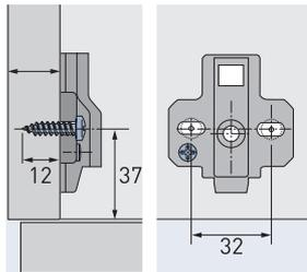
Ab 15mm Seitenstärke möglich, Lochabstand 32mm. Mit vormontierten Spannplattenschrauben. Exzenter-Höhenverstellung +/- 2mm. Zinkdruckguss vernickelt, Abstand Lochreihe 37mm.
