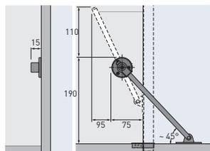
Mit Lager und Fuß zum Anschrauben. Stahl vernickelt/Kunststoff. Bremswirkung über Klemmschraube einstellbar. Die Klappe muss unten mit Klappenscharnieren angeschlagen werden.
