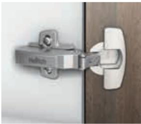
Automatikscharnier mit Aufklipstechnik, **mit integrierter Dämpfung**. Topfdurchmesser 35 mm. Mit Schließautomatik und integrierter Auflagenverstellung +/- 2 mm. Integrierte Exzenter Tiefenverstellung +3 mm/- 2 mm, Höhenverstellung über Montageplatte. Scharniertopf/-arm: Stahl vernickelt.
