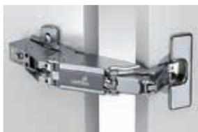
Automatikscharnier mit Aufklipstechnik, integrierter Auflagenverstellung + 2 mm / - 2 mm und integrierte Tiefenverstellung + 3 mm / - 2 mm. Höhenverstellung über Montageplatte. Scharnierarm Stahl vernickelt.
