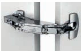
Schnellmontagescharnier mit integrierter Dämpfung. Null-Einsprung, Öffnungswinkel 165°. Für Türdicke 15-32mm, Topftiefe 11,6mm. Integrierte Auflagenverstellung +/- 2mm, Tiefenverstellung +3mm/-2mm. Höhenverstellung über Montageplatte. Stahl vernickelt.
