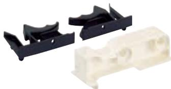
Zur sicheren, werkzeuglosen Verbindung von Quadro-Führung und Holzschubkasten. Stufenlose Höhenverstellung bis +2 mm über Rändelrad. Bei Demontage des Schubkastens bleibt die eingestellte Höhenposition arretiert. Kunststoff schwarz.
