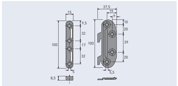
Stahl chromatiert. Komplett mit Kunststoffmuffen M6x13 und Schrauben M6x12.
